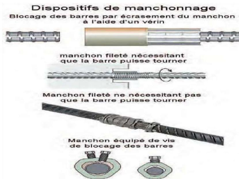
Figure.III.22: Assemblage d'armatures par manchonnage
