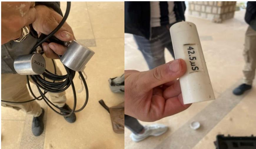
*Photo II. 5: Équipement de mesure non destructive pour diagnostic de structure*
