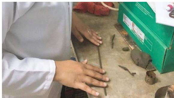
Fig.VII.8 : Essai pour la détermination de la limite de plasticité
