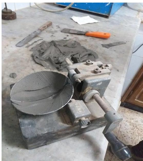
Fig.VII.7: Essai pour la détermination de la limite de liquidité.
