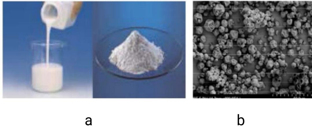
Figure I.3: PCM micro-encapsulés: (a) état liquide et état poudre :(b) image microscopique électronique à balayage de nombreuses capsules [11].
