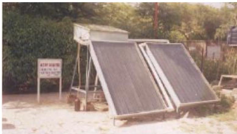
**Figure II.10 :** Système de distillation solaire actif
