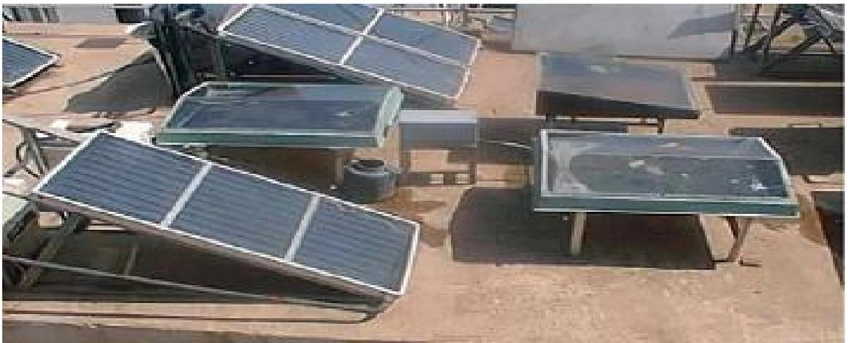
**figure II.5:** un distillateur couplé a un système de préchauffage de l'eau d'appoint
