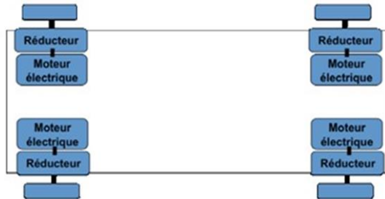
Figure III.4 : Motorisation multi-moteurs du véhicule électrique (motoréducteur répartis).
