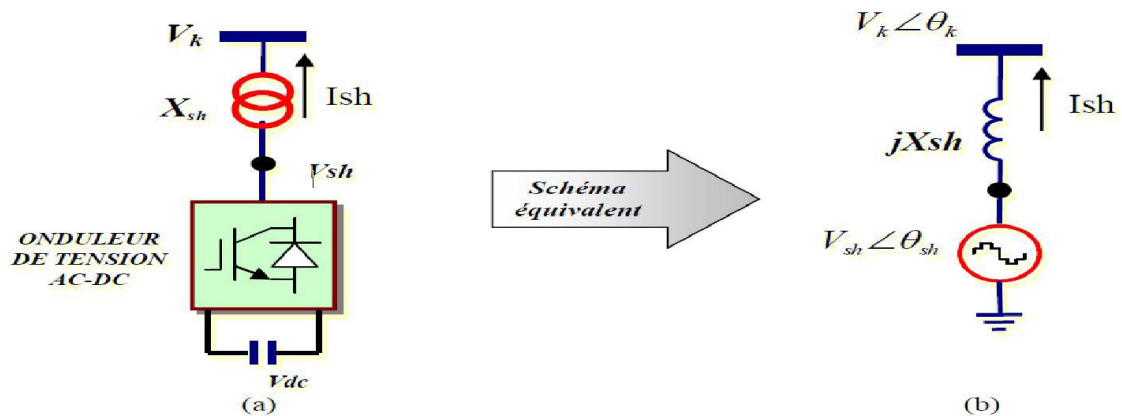
Figure II.33 : D-STATCOM, (a) structure de base, (b) schéma équivalent
