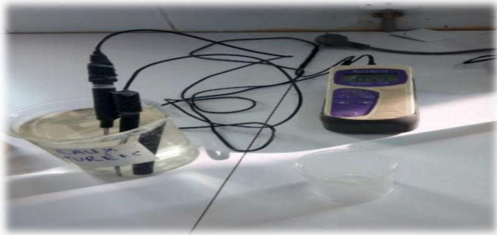
Figure (51) : La mesure de l'oxygène dissous (OD) par un oxymétrie.
