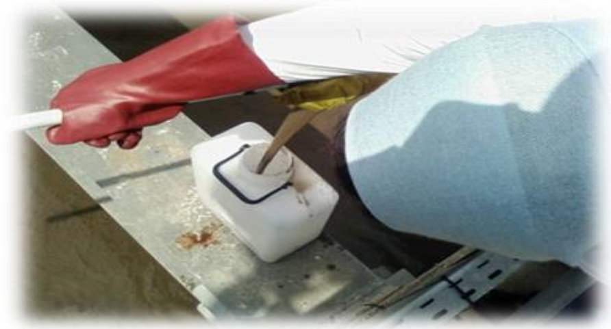
Figure (45) : Point de prélèvement des boues activées au niveau de chenal anoxie-aérobie.
