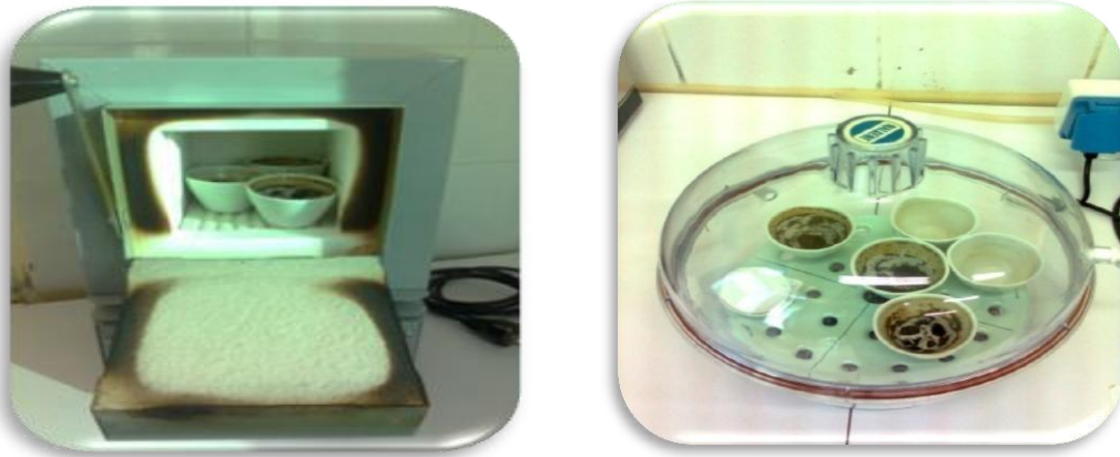
Figure(58): Détermination de la concentration en MVS des boues.
