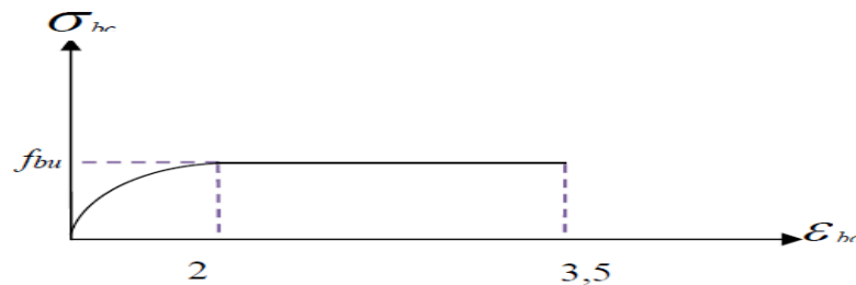
Figure I-7: Diagramme contraintes-déformations du béton à L'ELU.
