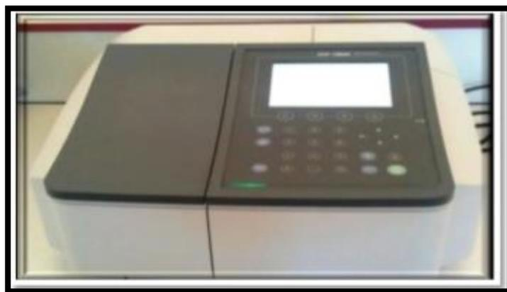
**Figure 26:** Spectrophotomètre.
