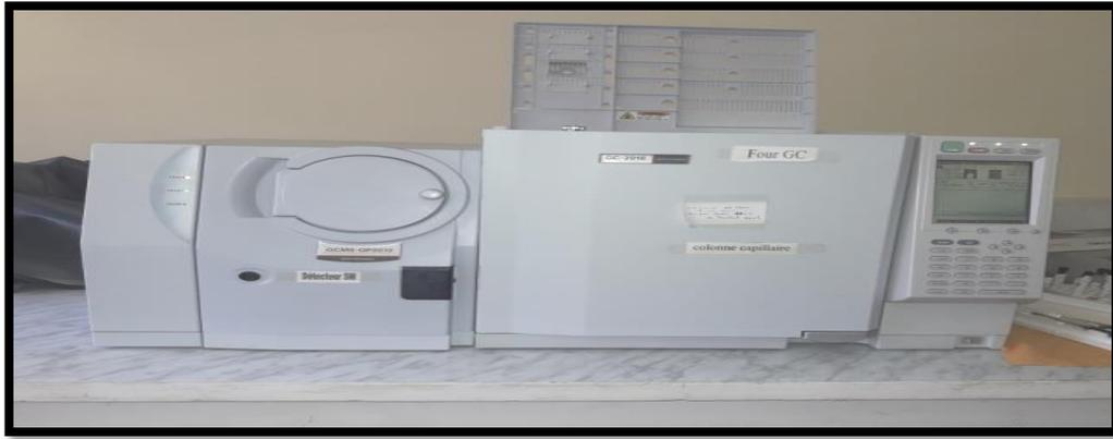
**Figure 17:** Chromatographie en phase gazeux couplé au spectrométrie de masse S.N.V Jijel.
