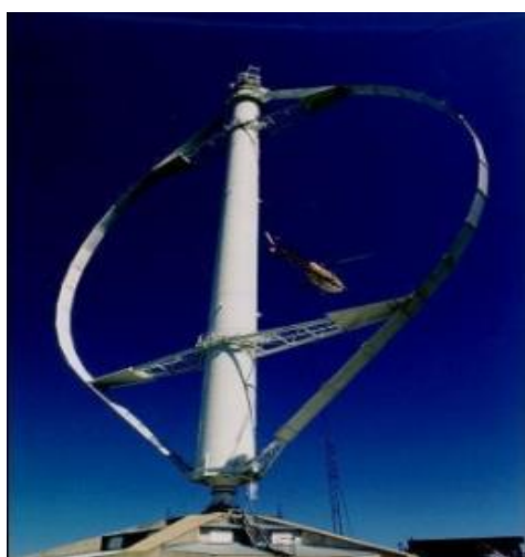
Eolienne de type Darrieus
