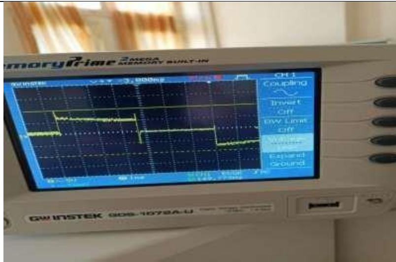
Fig.III.22 : Tension à la sortie du circuit vue sur l'oscilloscope.
