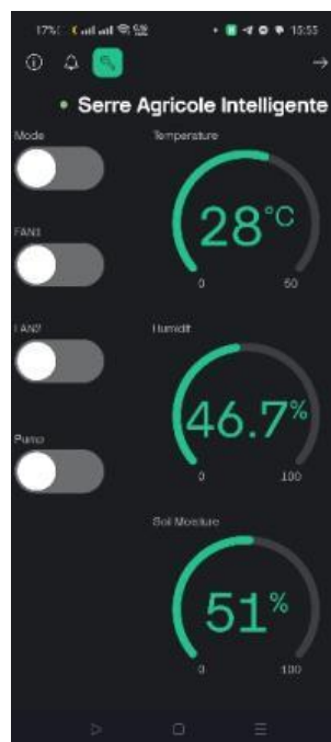
Figure III-36 Contrôle manuel depuis l'application mobile (mode manuel).
