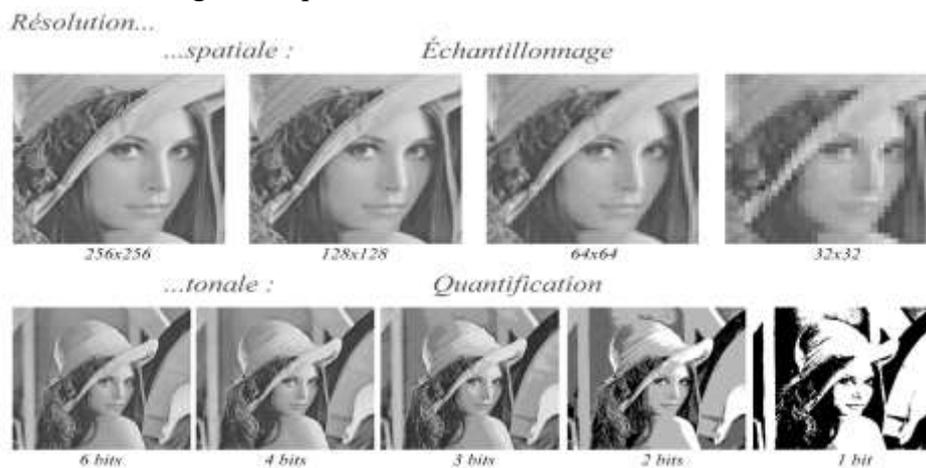
Figure 1. 11: Combinaison de l'échantillonnage et de la quantification
