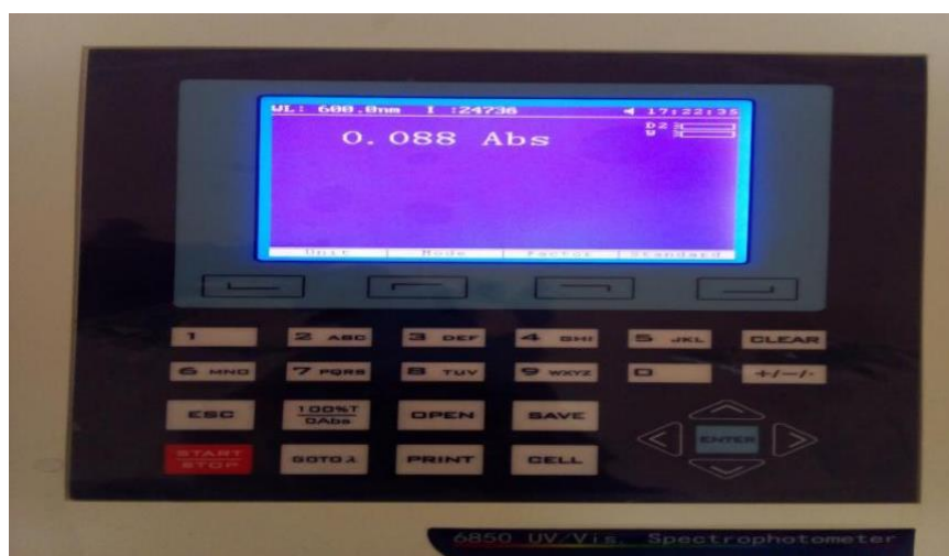
Figure 18 : Mesure de la densité optique (DO) par un spectrophotomètre.
