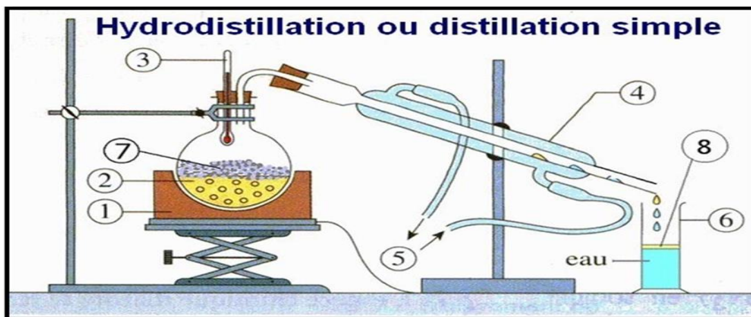
Figure 2 : Schéma du principe de la technique d'Hydrodistillation.(Lucchesi 2005)
