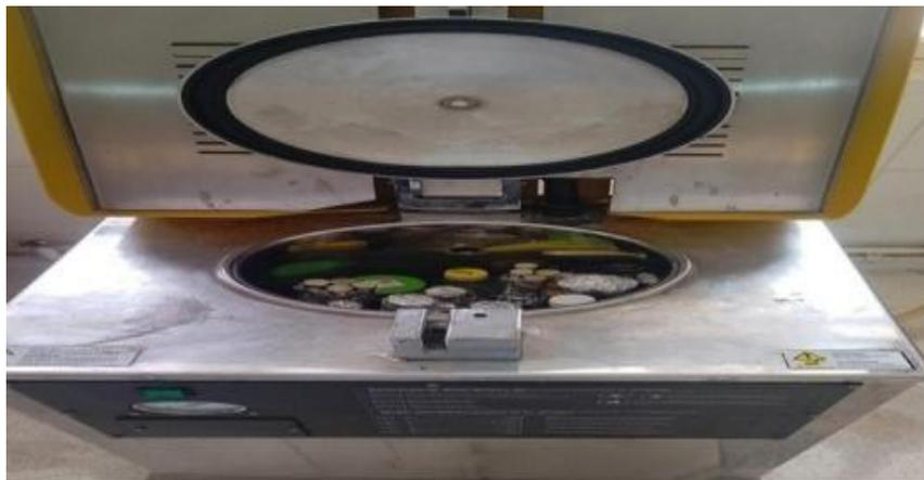
**Figure 29** : Stérilisation du matériel dans l'autoclave (Photo personnelle).
