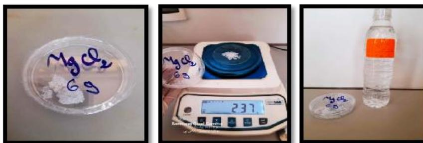
Figure 13 : Préparer une solution de  $\text{MgCl}_2$ .
