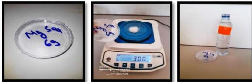
Figure 15 : Préparer une solution de MgSO<sub>4</sub>.
