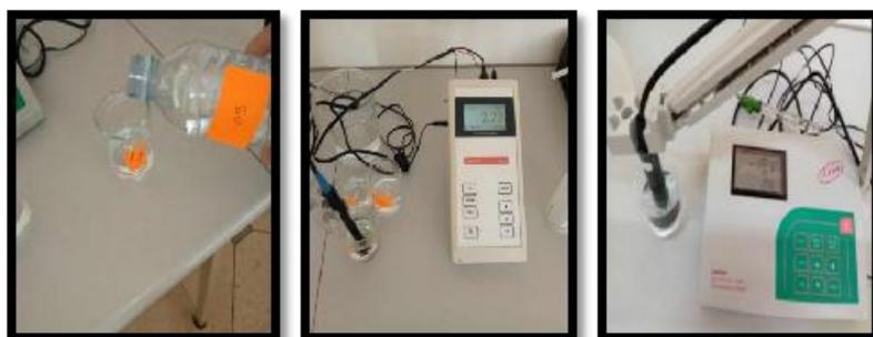
**Figure 28** : Méthode de mesure du pH et la Conductivité.
