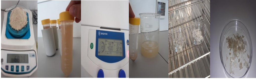
Figure 14 : les étapes de purification de la gomme brute de caroube (photo original)
