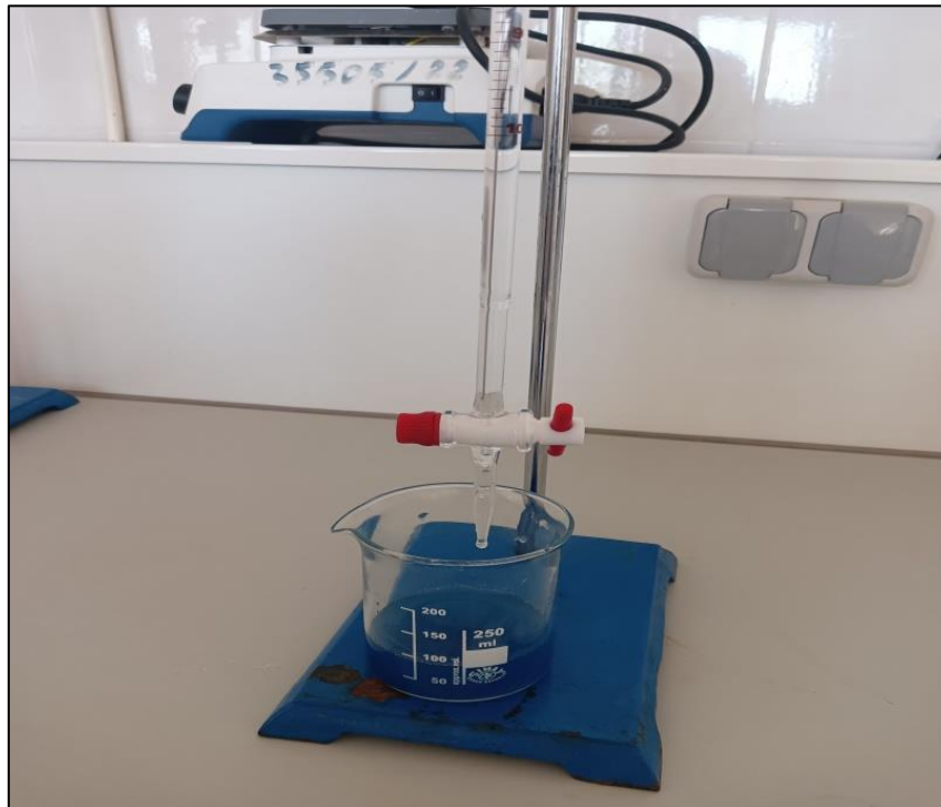
Figure 29: Calibrage colorimétrique de ( \text{Mg}^{+2} )
