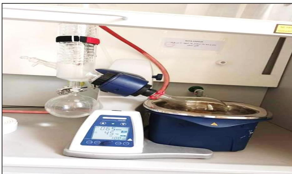
**Figure 20:** Evaporation à l'aide d'un rotavap (Photo personnelle).
