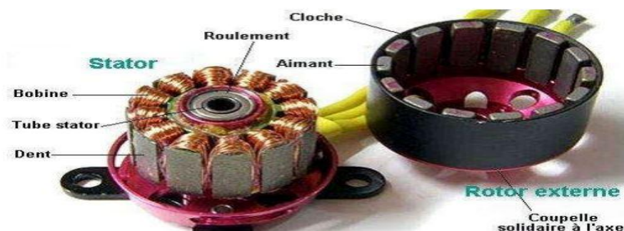
Figure II.10 : La constitution du moteur BLDC
