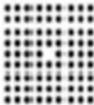
Figure III.1. cavité carrée dans un cristal photonique carré avec un paramètre de maille 600 nm [58]
