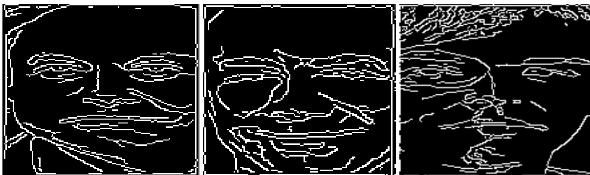
Figure III.14. Résultat de la détection de contours par l'algorithme de Canny appliqué à la région du visage.
