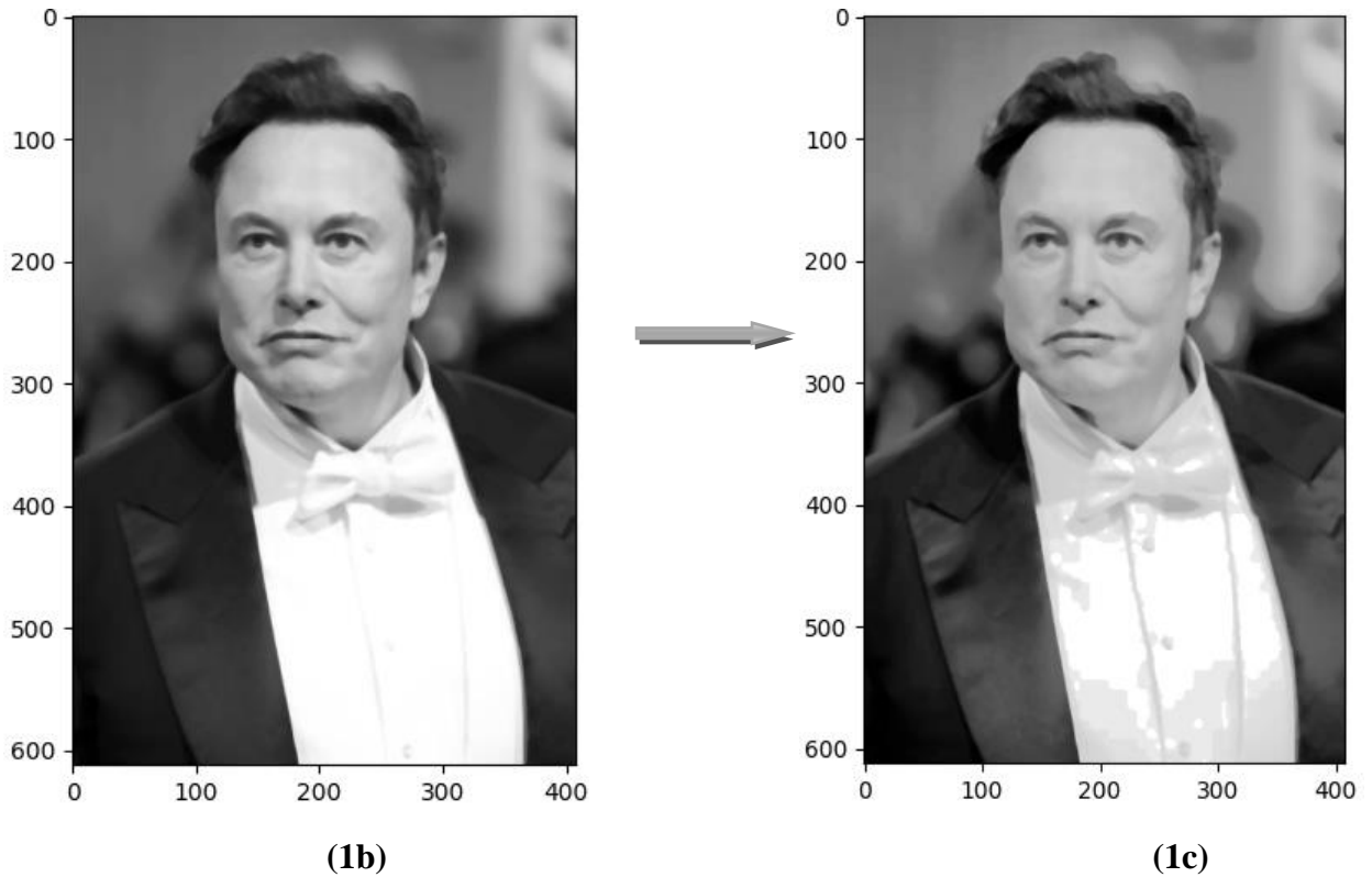
Figure III.8. Effets de l'égalisation d'histogramme sur la qualité de la première image; (1b) : image filtrée ; (1c) : image égalisée après correction.
