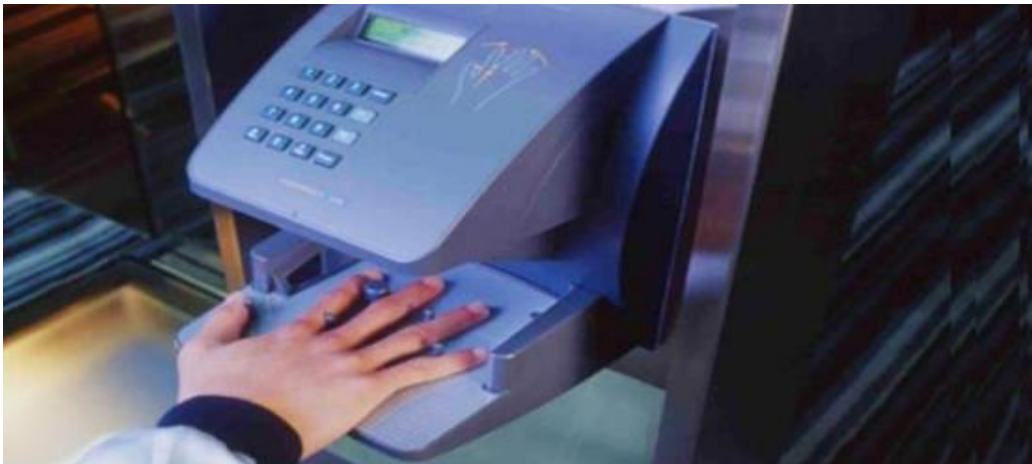
Figure I.5. Système de reconnaissance biométrique par géométrie de la main [6].
