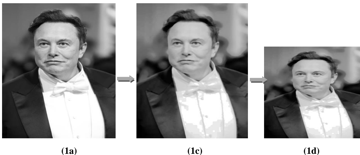
Figure III.10. Redimensionnement d'images considéré; (1a): image au niveau de gris; (1c): image égalisée; (1d): image redimensionnée.
