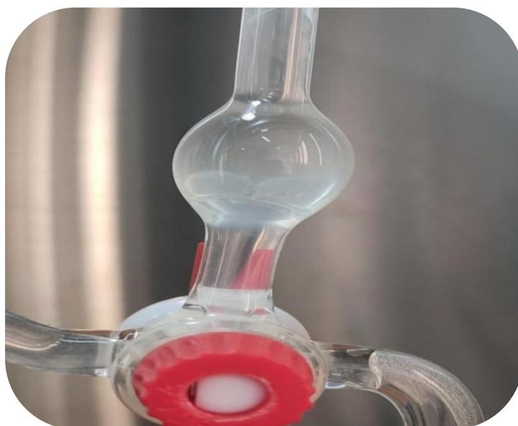
Figure 10 : Séparation de l'huile essentielle de laurier noble et l'hydrolat, photo originale (06/02/2023).
