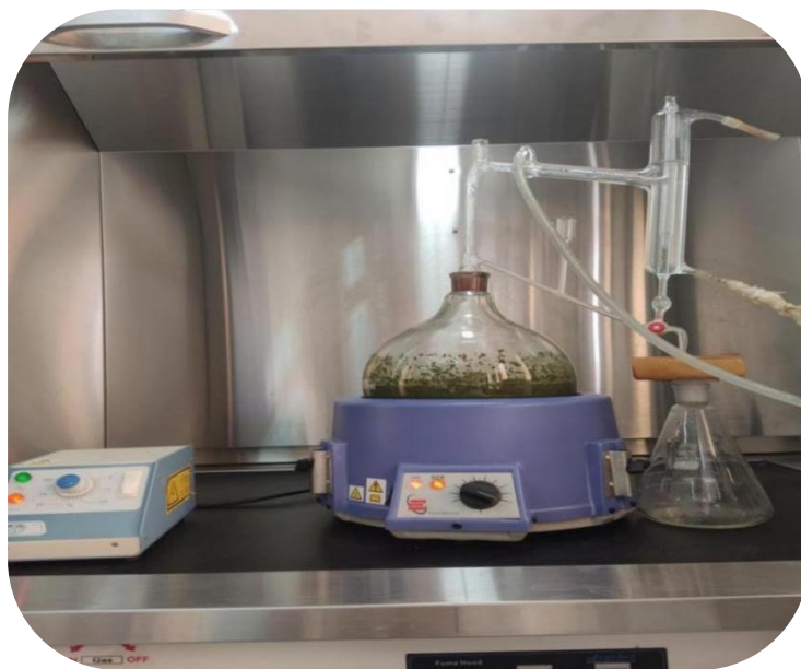
Figure 09 : Montage d'hydrodistillation de type Clevenger, photo originale (06/02/2023).
