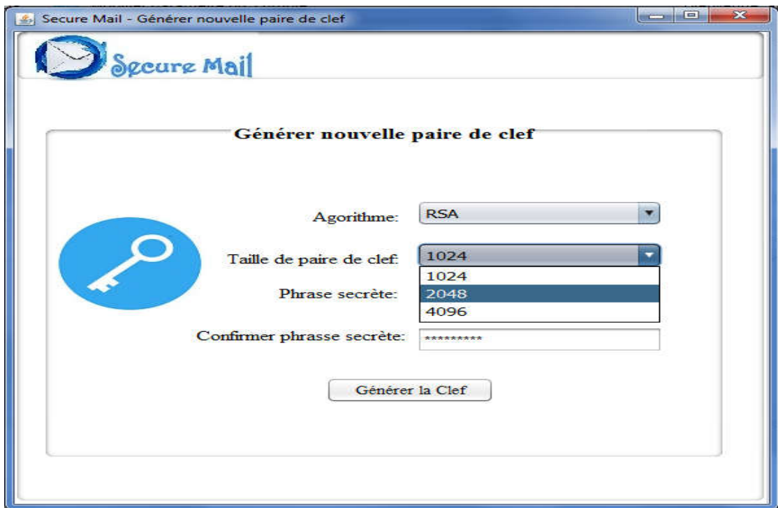
Figure 40: Fenêtre de création d'une nouvelle paire de clef RSA.
