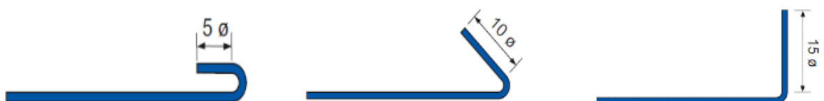
Fig. 3-8 : Ancrage des cadres, étriers et épingles.
