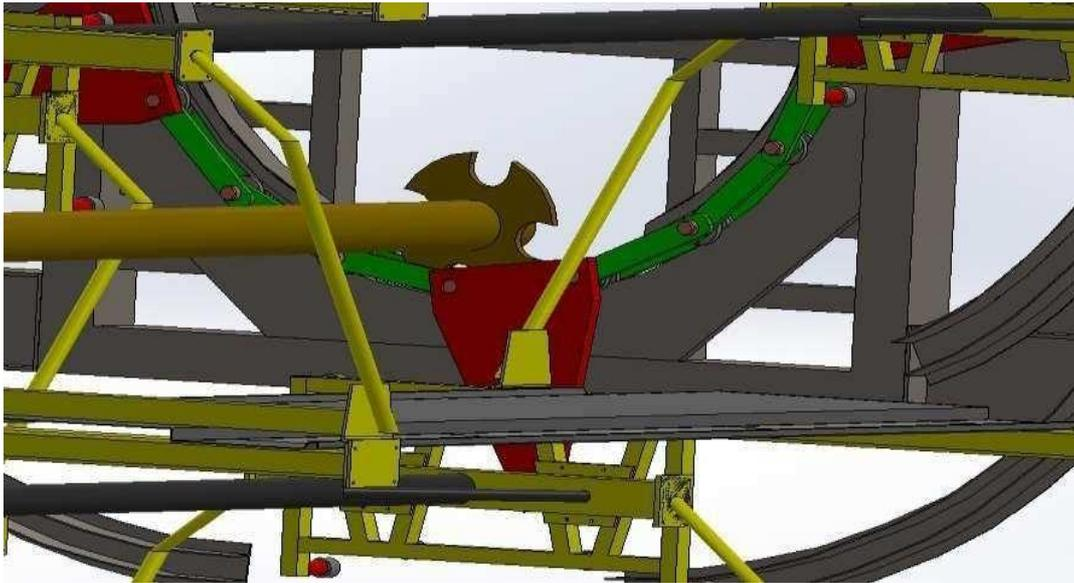
**Figure III.16 : Système de traction à l'aide de l'axe de poussée et de la chaîne.**
