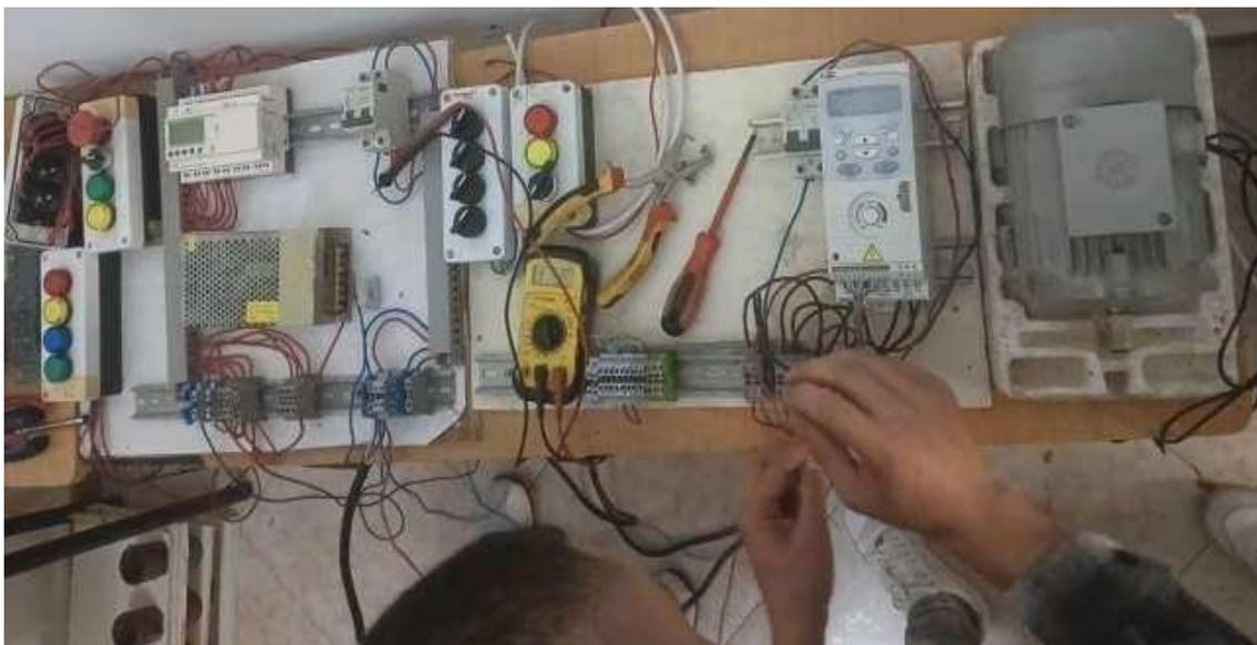
**Figure III.19 : la réalisation du câblage**
