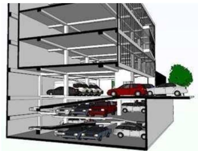
Figure II.4 : Stationnement à étages multiples [7].
