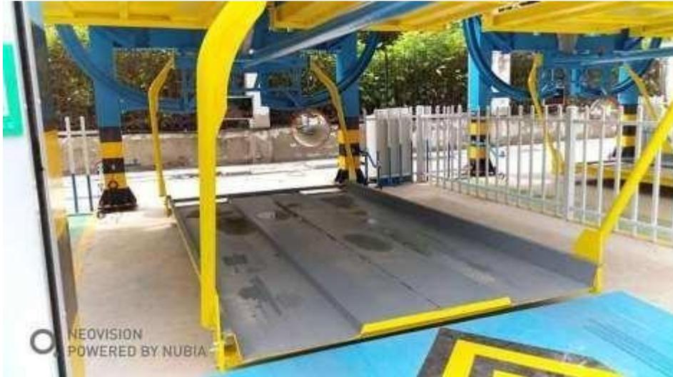
**Figure II.8 : palette Type Rotatif vertical [9].**
