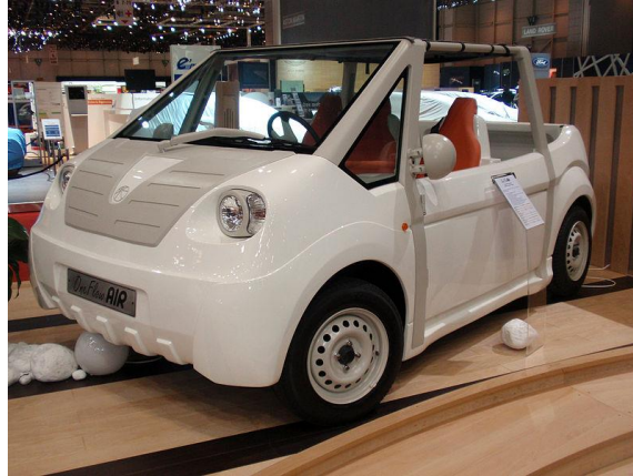
Figure (VI.8): Prototype d'automobile propulsée par un moteur à air comprimé, développé par la société MDI
