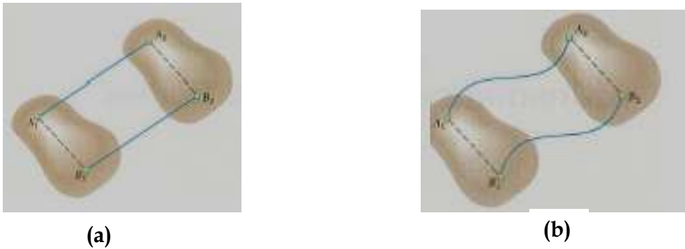
Figure (IV.2): (a) : Mouvement de translation rectiligne, (b) : mouvement de translation curviligne
