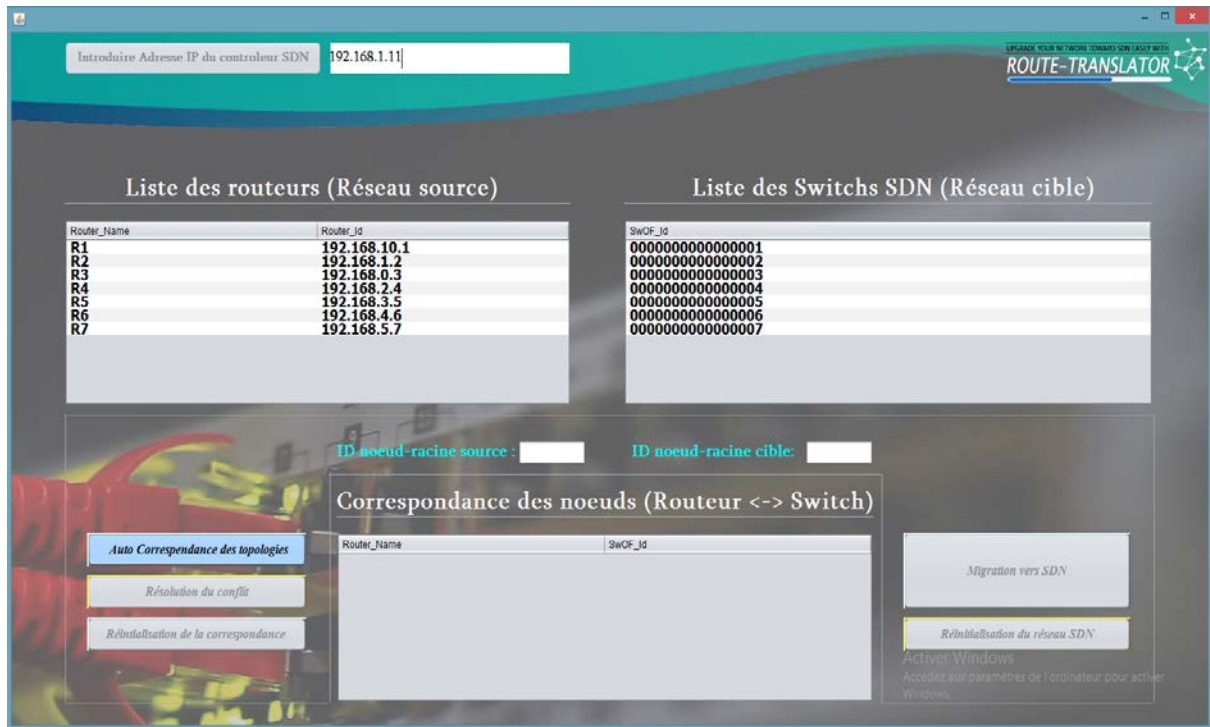
Figure 3.20 : Introduction de l’adresse IP du contrôleur SDN.
