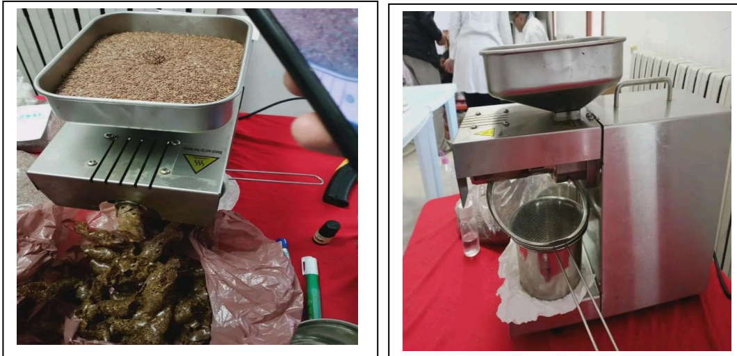
Figure 18 : Extraction de l'huile de graines de Lin par pressage à froid
