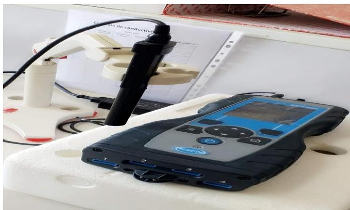
**Figure 177** : Conductimètre de marque Hach (**Photo personnel**)
