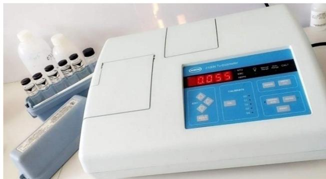
Figure 18 : Turbidimètre de marque Hach (photo personnel).
