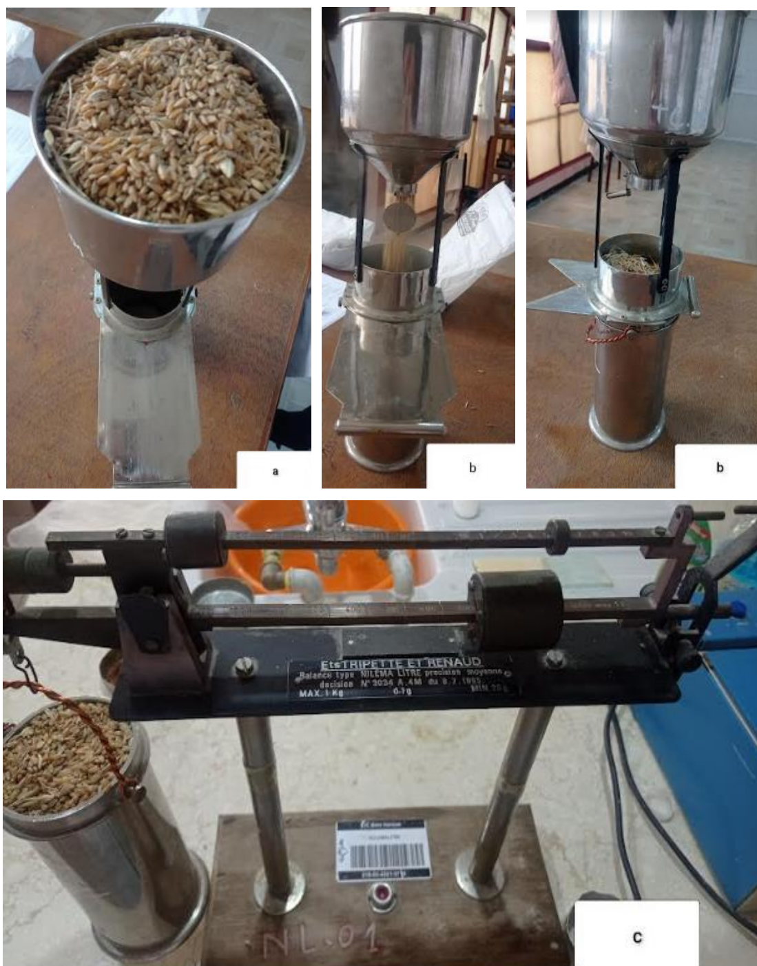
Figure 7: Photos représentative de la méthode utilisée pour mesurer le PS (photo personnelle, 2023).
