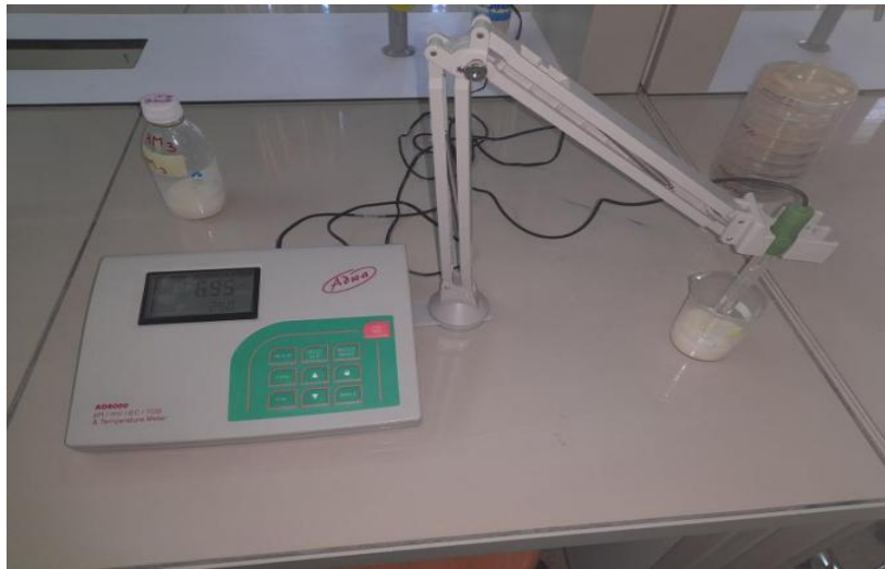
Figure 27 : Suivi du pH du lait réfrigéré à 4°C et supplémenté avec de l'HE de M. communis pendant 8 jours.
