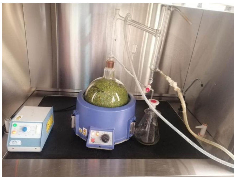
Figure 08 : Photographie originale du montage d'hydrodistillation de type Clevenger.
