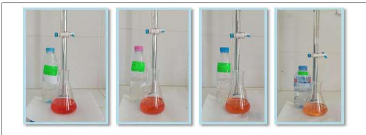
**Figure 20:** Dosage pour déterminer TAC
