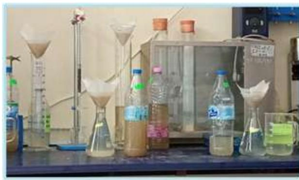
**Figure 16:** Filtration sur fibre de verre
