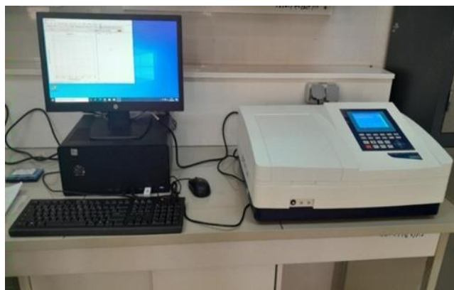
Figure III-12 : Image de la spectroscopie UV-Vis de Type (JENWAY 6850)
