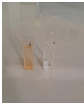
Figure III-19 : Aspect d'effluent de MO avant et après le traitement par l'adsorption sur l'argile
