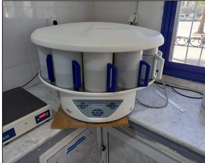
Figure 19 : Automate de déshydratation STP 120
