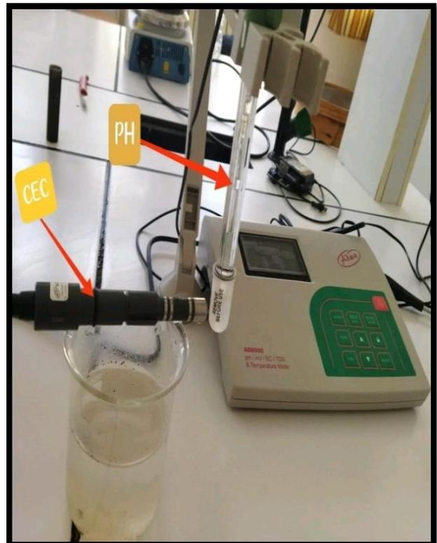
**Figure 36** : Photo original de la mesure de la conductivité électrique.
