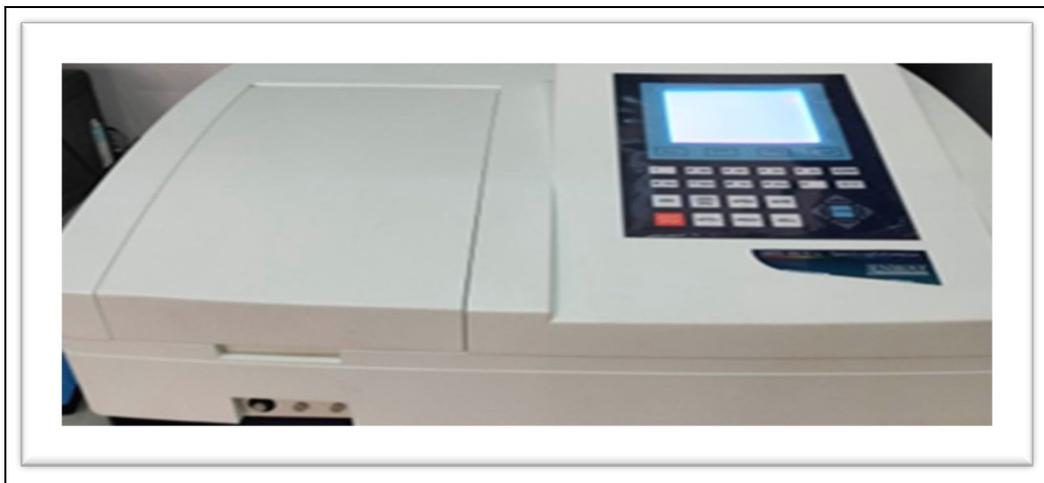
Figure18 : spectromètre UV-Visible à 750 nm.
