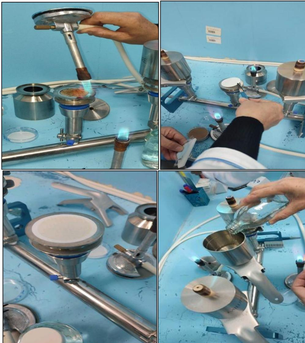
**Figure 18.** Les étapes d'analyses par filtration.
