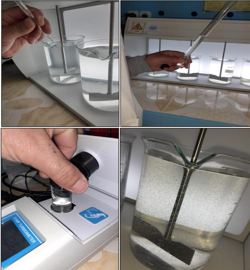
Figure 17. Etapes d'analyse jar-test.
