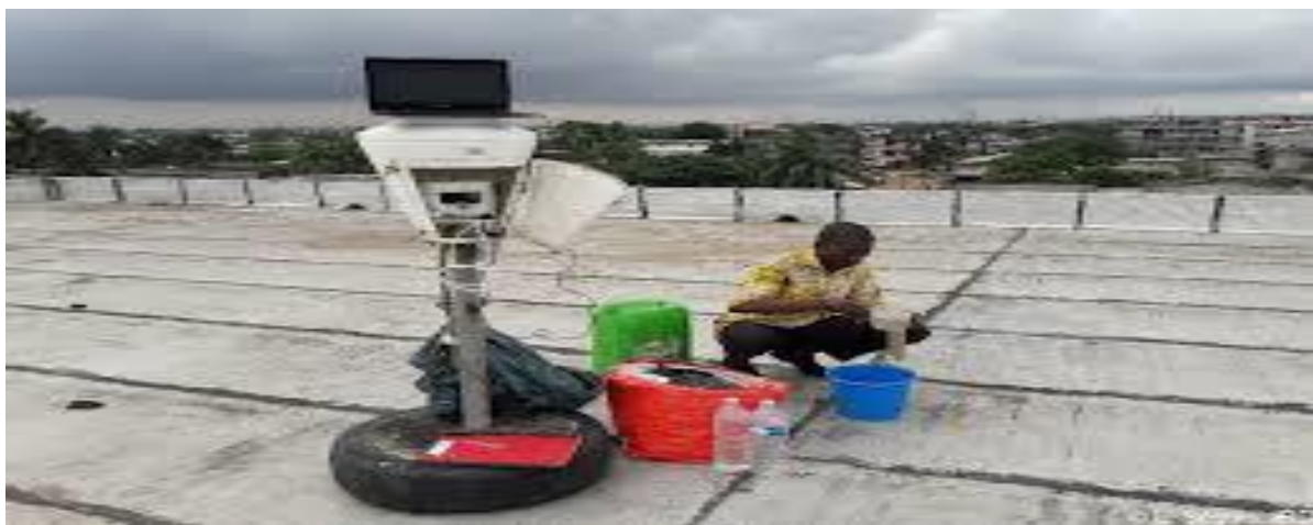
Figure 6 : Relève d'un pluviographe (Site collège Ste Foi, Abobo)
