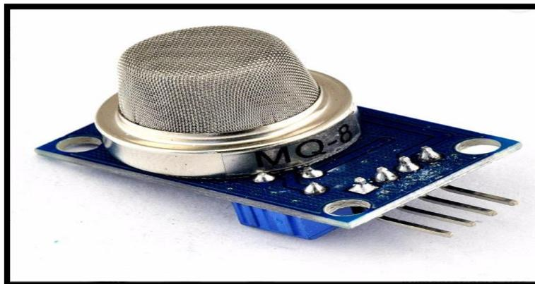
Figure 3. 3: Capteur de gaz hydrogène.
