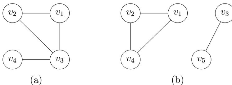
FIGURE 1.5 – (a) Graphe connexe et (b) Graphe non connexe
