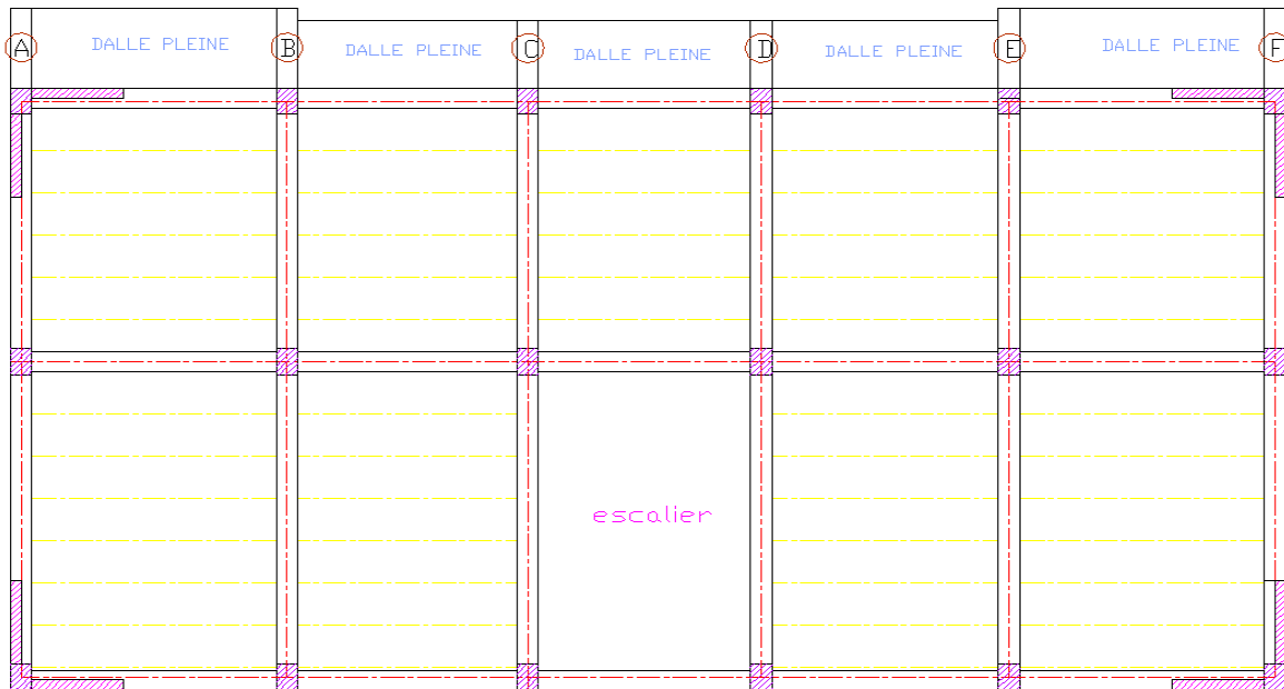
Figure III.5 : Dispositions des voiles.
