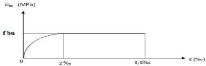
Figure I. 8:Diagramme contraintes-déformations du béton à l'ELU.
