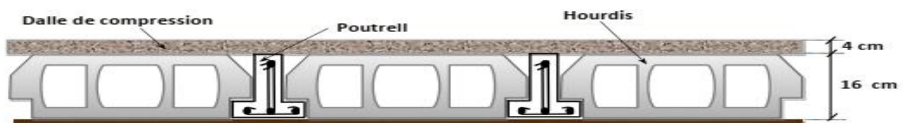
Figure II. 1: Plancher à corps creux 16+4
