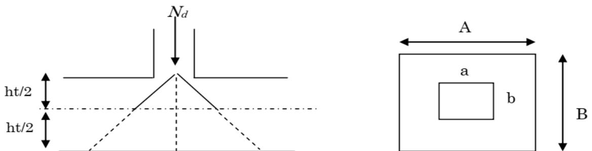
**Figure VI.1.** Présentation de zone d'impact de la charge concentrée
