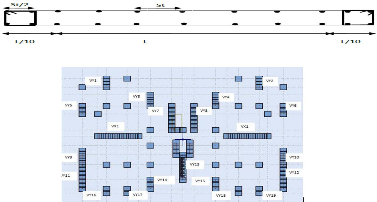
**Figure V.11.** Disposition des armatures verticales (vue en plan).
