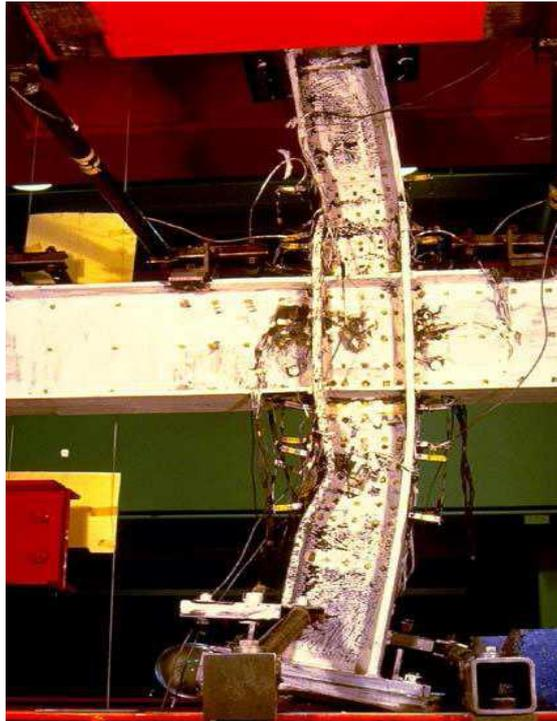
Figure I.14. Test Poteau faible – poutre forte.
