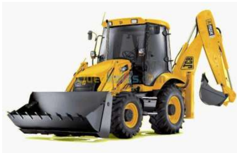
Photo .4 : 'retro' pour l'exécution des tranchées
