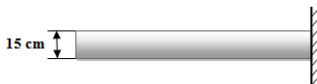
Figure II.10: L'épaisseur du balcon.
