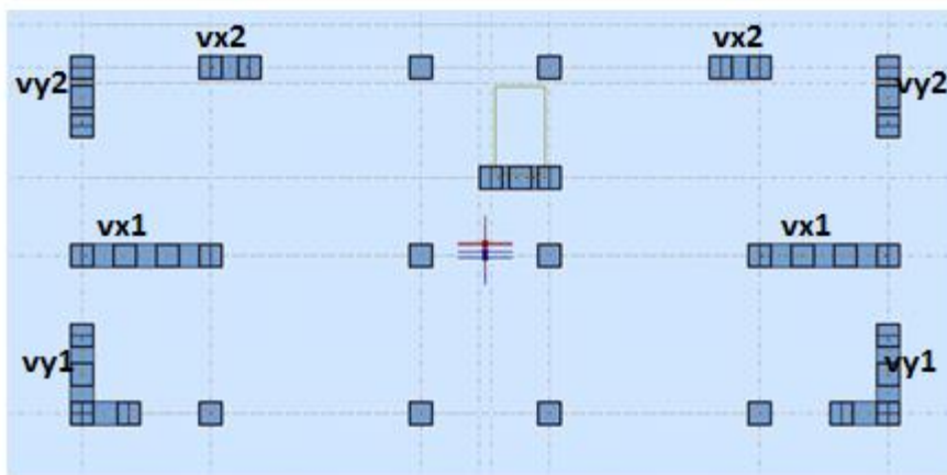
Figure : V.7. Disposition des voiles.
